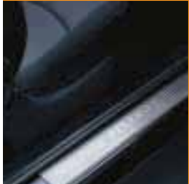
Protection de seuil de porte
